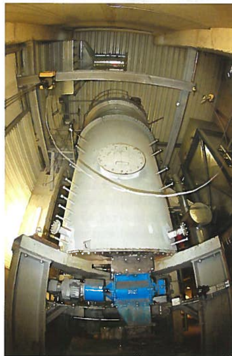
Der Gegenstromvergaser ist das Herzstück der Kombi Fire und Kombi Power Systeme.
