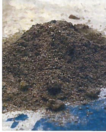
Der vollständige Ausbrand sorgt für eine koksfreie Asche.
